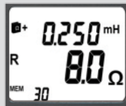
Skärm 3: Värdet på resistiv och induktiv del
